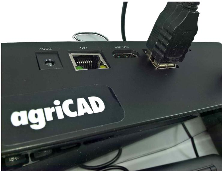
Il computer è equipaggiato con 4 Porte USB. Due Laterali per connettere l'antenna e la chiave di utilizzo. Due superiori chiuse e da utilizzare solo quando si usa il computer in ufficio. Utilizza il sistema Operativo Windows 10
